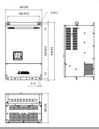
(5) N700E-750HF/900HFP, N700E-900HF/1100HFPmodel external dimension.(mm)
