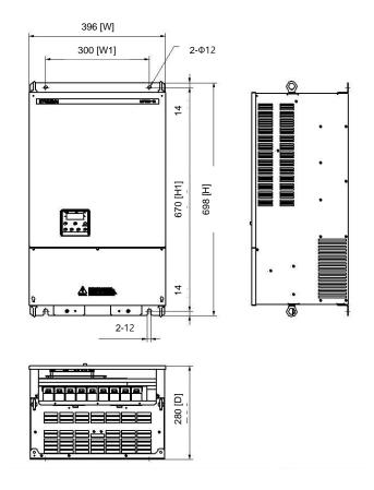
(6) N700E-1100HF/1320HFP, N700E-1320HF/1600HFPmodel external dimension.(mm)
